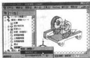
图9-17 展开焊缝零件后的装配体特征管理器设计树
