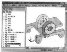
图 9-14 添加焊缝零件后的装配体
